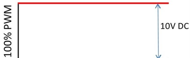
Dados técnicos 0-10V: 0-10V: 2V a 10V (20% a 100%) Projetado para uma carga de 10K Ohm. 10V = 100% Velocidade 5V = 50% Velocidade 2V = 20% Velocidade 0V = Desligado
