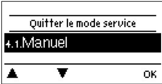
Pour fixer les modes de service du fonctionnement de l'installation. Après une coupure de courant le régulateur revient au dernier réglage du mode de service !
