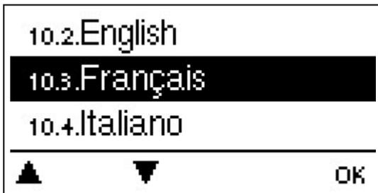
Ce menu permet de choisir la langue pour le pilotage des menus. Lors de la première mise en service et des coupures de courant prolongées, l'interrogation s'effectue automatiquement. Le choix des langues peut différer selon le modèle. La sélection de la langue n'est pas disponible pour tous les modèles.
