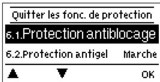
Le menu « Fonctions de protection » permet d'activer et de régler diverses fonctions de protection.
