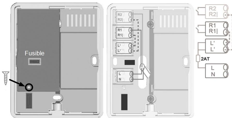
Desatornillar el tornillo, quitar la cubierta del cable y conectar el eléctrico como es descrito.
