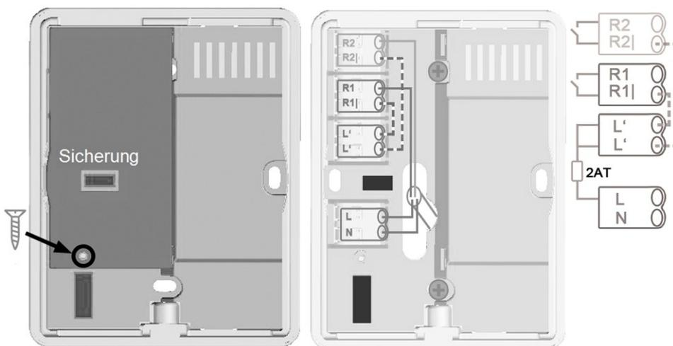
Schraube lösen, Kabelabdeckung entfernen und wie beschrieben den Elektroanschluss vornehmen.
