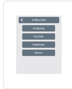
**Ausgang:** Schaltausgang der Funktion.
