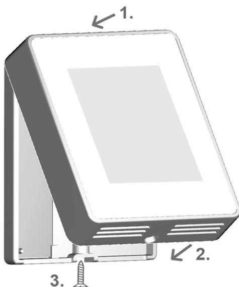
Das Bedienteil wieder einhängen und mit der Schraube verschließen. Netzspannung einschalten und °CALEON in Betrieb nehmen.
