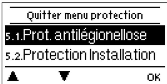
Le menu « Fonctions de protection » permet d'activer et de régler diverses fonctions de protection.
