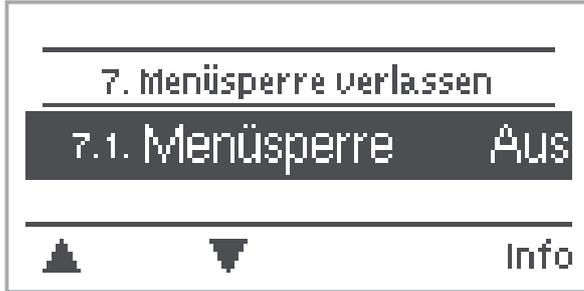
Durch das Menü "7. Menüsperre" kann der Regler dagegen gesichert werden, dass die eingestellten Werte unbeabsichtigt verstellt werden.
