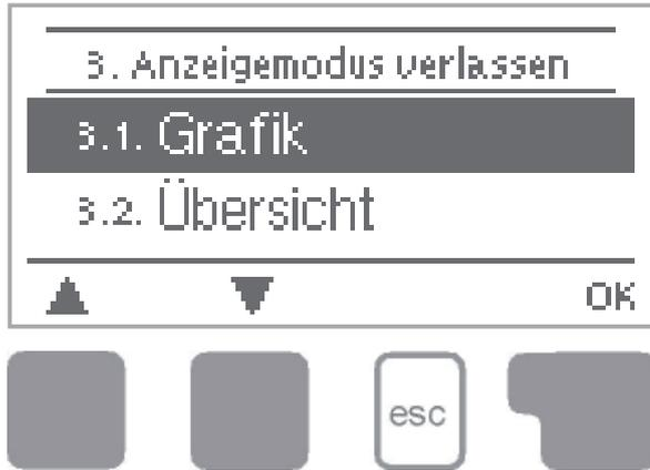
Im Menü "3. Anzeigemodus" wird die Displayanzeige des Reglers für den Normalbetrieb festgelegt.
