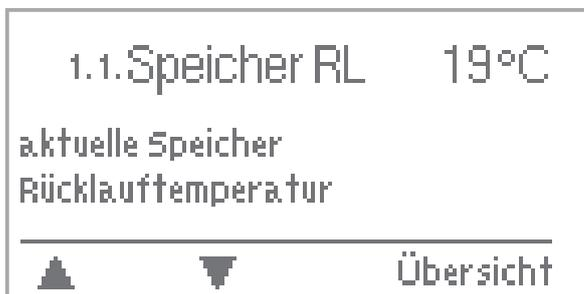
Die Messwerte werden bei Auswahl von Info mit einem kurzen Hilfetext erläutert.
