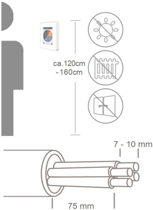
Montieren Sie das Gerät an geeigneter Stelle.
