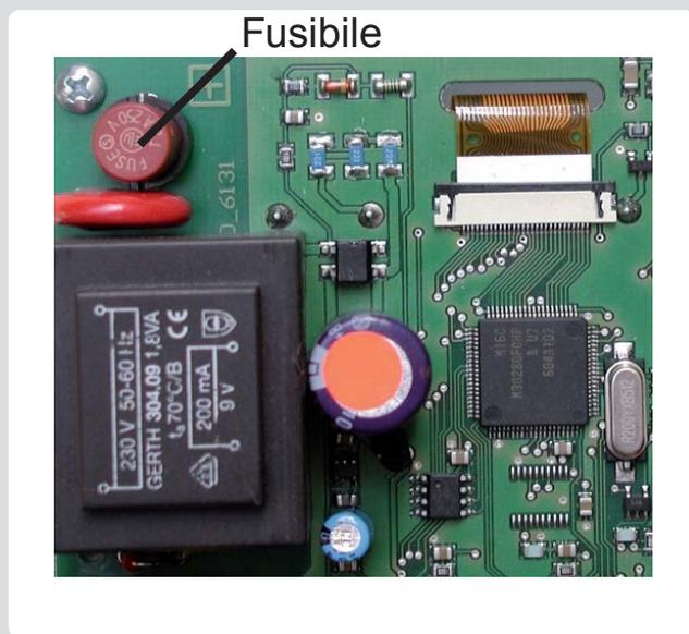
Se l'alimentazione è attiva e la centralina non funziona ancora o non appare nulla nel display, allora il fusibile interno potrebbe essere difettoso. In questo caso, aprire la centralina come descritto in C, togliere il vecchio fusibile e controllarlo. Sostituire il fusibile difettoso con uno nuovo, cercare la fonte esterna di guasto (es. pompa) e sostituirla. Per prima cosa, impostare la centralina e controllare il funzionamento delle uscite nella modalità manuale come descritto in 5.2.
