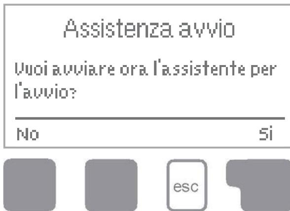
La prima volta che la centralina viene accesa, e dopo aver impostato lingua e ora, appare la domanda se si vuole impostare la centralina con la funzione assistenza alla programmazione o no. La funzione assistenza alla programmazione può essere chiusa o nuovamente richiamata in un secondo tempo in funzioni speciali del menù.
