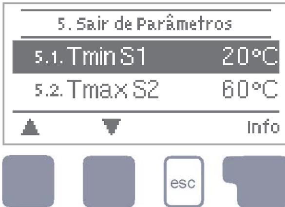
As definições básicas necessárias para a função de controlo são efectuadas no menu "5. Parâmetros"
