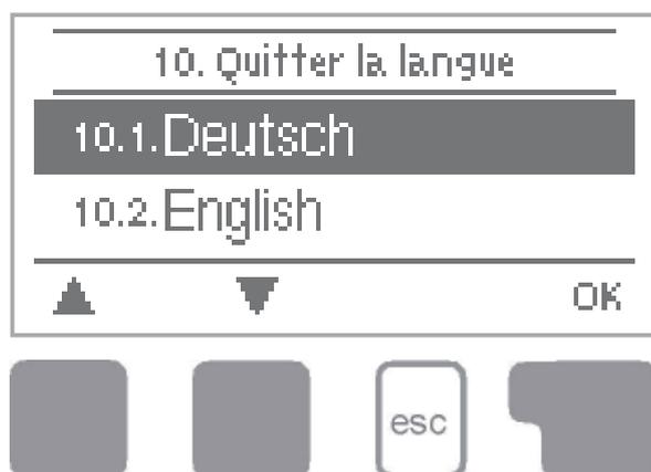
Le menu « 10. Langue » permet de sélectionner la langue de l'interface. Lors de la première mise en service, la demande de sélection est automatique.
