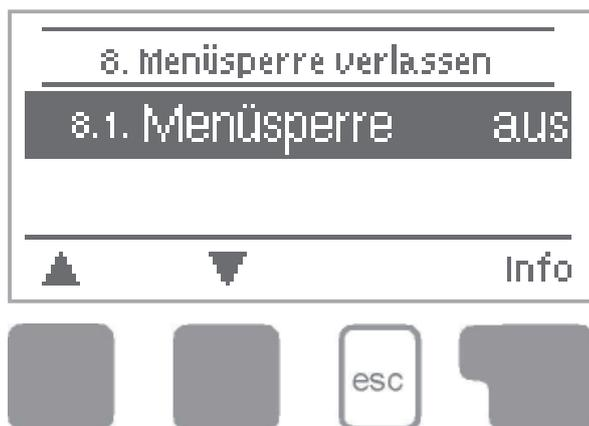
Durch das Menü "8. Menüsperre" kann der Regler dagegen gesichert werden, dass die eingestellten Werte unbeabsichtigt verstellt werden.
