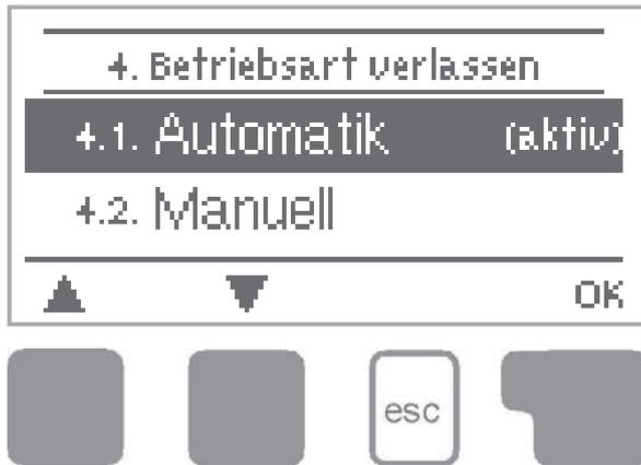
Im Menü "4. Betriebsarten" kann der Regler neben dem Automatikbetrieb auch ausgeschaltet oder in einen manuellen Betriebsmodus versetzt werden.
