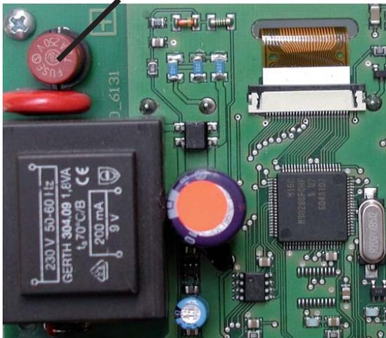
Se l'alimentazione è attiva e la centralina non funziona ancora o non appare nulla nel display, allora il fusibile interno potrebbe essere difettoso. In questo caso, aprire la centralina come descritto in C, togliere il vecchio fusibile e controllarlo. Sostituire il fusibile difettoso con uno nuovo, cercare la fonte esterna di guasto (es. pompa) e sostituirla. Per prima cosa, impostare la centralina e controllare il funzionamento delle uscite nella modalità manuale come descritto in 4.2.
