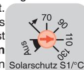
Nach Aufstecken des Reglermoduls auf den Anschlußsockel ist die Einstellung für solare **Speicheraufladung Tmax** von 20-90°C vorzunehmen. (Vorschlag: 60°C) (Hysterese: 20-39°C=1K, 40-90°C= 4K)
