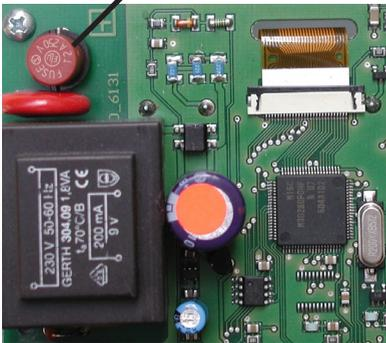
Si, malgré activation de la tension de réseau, le régulateur ne fonctionne plus et que l'afficheur est éteint, il se peut que le fusible d'appareil interne soit défectueux. Il faut alors ouvrir l'appareil, comme décrit au point C, retirer l'ancien fusible et le vérifier.
