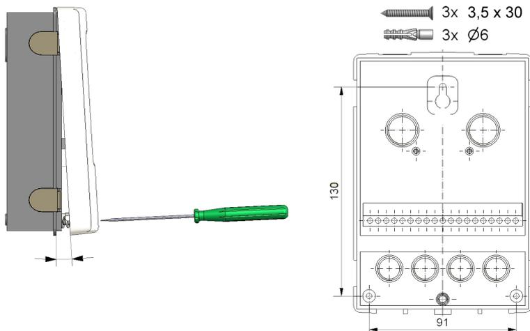
1. Deckelschraube komplett lösen.
