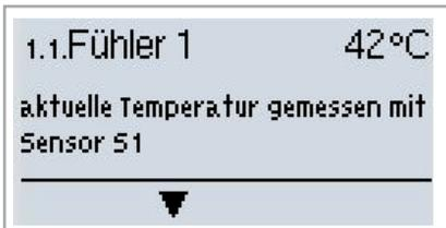
Die Messwerte werden bei Auswahl von Info mit einem kurzen Hilfetext erläutert.
