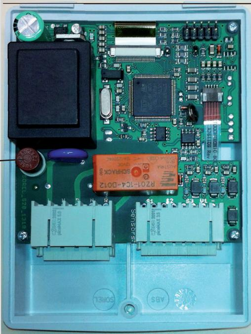
Hat der Regler trotz eingeschalteter Netzspannung keine Funktion und Anzeige mehr, so ist es möglich, dass die interne Gerätesicherung defekt ist. Dann das Gerät wie unter C.1. beschrieben öffnen, alte Sicherung entfernen und überprüfen.
