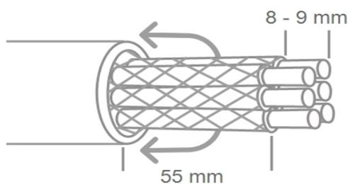
Pelar cables, deslizar el conductor de protección, y eliminar el material de relleno según sea necesario.
