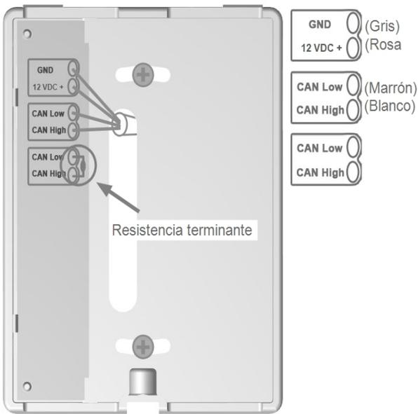
Abra los terminales con la herramienta incluida y haga la conexión eléctrica como se describe.
