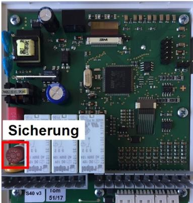
Hat der Regler trotz eingeschalteter Netzspannung keine Funktion und Anzeige, ist evtl. die interne Gerätesicherung defekt. Dann das Gerät wie unter siehe "Wandmontage" auf Seite 8 beschrieben öffnen, alte Sicherung entfernen und überprüfen.
