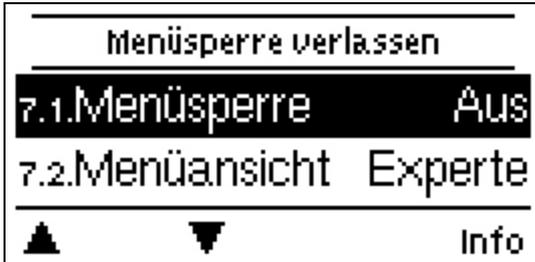
Durch aktivierte Menüsperre können die eingestellten Werte gegen unbeabsichtigtes Verstellen gesichert werden. Die Funktion kann im Menü Ein/Aus gestellt werden.
