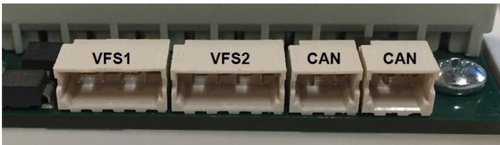
Die Polung der Pt1000 Fühler ist beliebig. Relaisbelegung ist abhängig von den ausgewählten Zusatzfunktionen. Der VFS Sensor wird direkt in die Buchse auf der Leiterplatte im Sensorklemmbereich eingesteckt.
