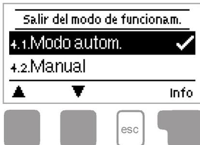
Bajo el menú “4. Modo de funcionamiento” el regulador se puede apagar, operar en automático u operar en manual.
