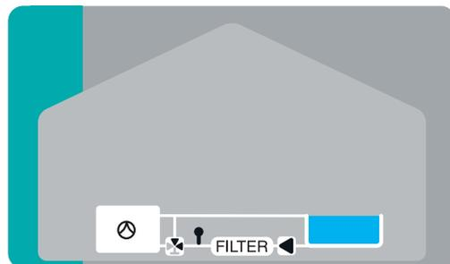
Piscina con bomba de calor, válvula esférica y control de bomba de filtrado
