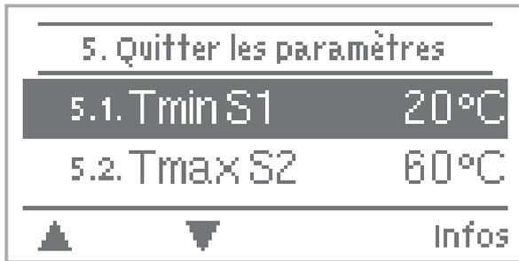
Le menu « 5. Paramètres » permet d'effectuer les réglages de base nécessaires au fonctionnement du régulateur.
