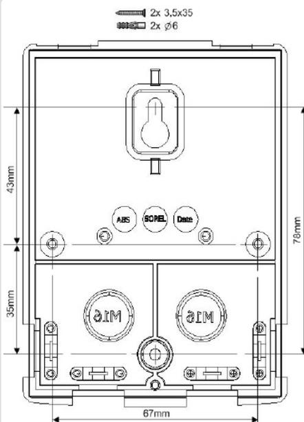
5. Use uma broca de 6mm para efectuar os 2 furos nos pontos marcados na parede e coloque as buchas. Também possível a instalação com 4 furos.
