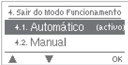
No menu „4. Modos de operação“ o controlador pode ser colocado em modo automático, desligado, ou colocado em modo manual.
