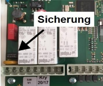
Hat der Regler trotz eingeschalteter Netzspannung keine Funktion und Anzeige, ist evtl. die interne Gerätesicherung defekt. Zuerst die externe Fehlerquelle (wie z.B. Pumpe) finden, austauschen und danach die Gerätesicherung überprüfen.
