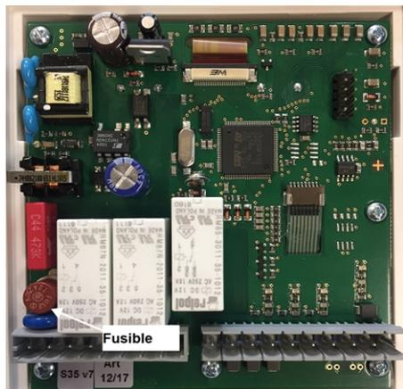
Si la tensión de alimentación se enciende y el regulador aun no funciona o no da imagen, es posible que el fusible del dispositivo interno esté averiado. En ese caso, abra el dispositivo como se describe en la sección C, quite el fusible anterior y verifíquelo.
