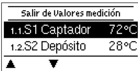
Sirve para visualizar las temperaturas actuales obtenidas en la medición.
