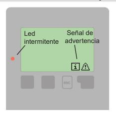
Si hay una malfunción, se activa una luz intermitente y en la pantalla aparece una señal de advertencia. Si el error desaparece, cambia la señal de advertencia a una de información y la luz se desactiva. Pulsando la tecla abajo del señal se optiene mas información
