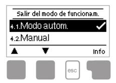
Bajo el menú "4. Modo de funcionamiento" el regulador se puede apagar, operar en automático u operar en manual.
