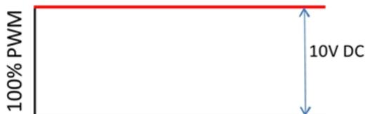
Dati tecnici 0-10V: 0-10V: da 2V a 10V (da 20% a 100%) Progettato per un carico di 10K Ohm. 10V = velocità 100% 5V = velocità 50% 2V = velocità 20% 0V = Off
