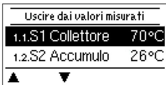
Visualizzazione delle temperature misurate correnti.
