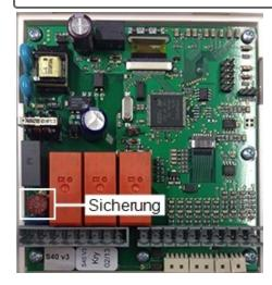
Hat der Regler trotz eingeschalteter Netzspannung keine Funktion und Anzeige, ist evtl. die interne Gerätesicherung defekt. Zuerst die externe Fehlerquelle (wie z.B. Pumpe) finden, austauschen und danach die Gerätesicherung überprüfen.
