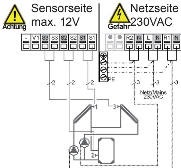
**Kleinspannungen** max. 12VAC/DC Anschluss im linken Klemmraum!
