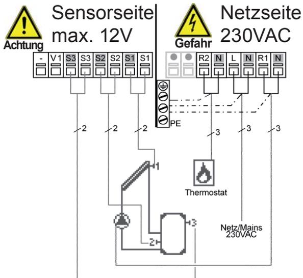
**Kleinspannungen** max. 12VAC/DC Anschluss im linken Klemmraum!
