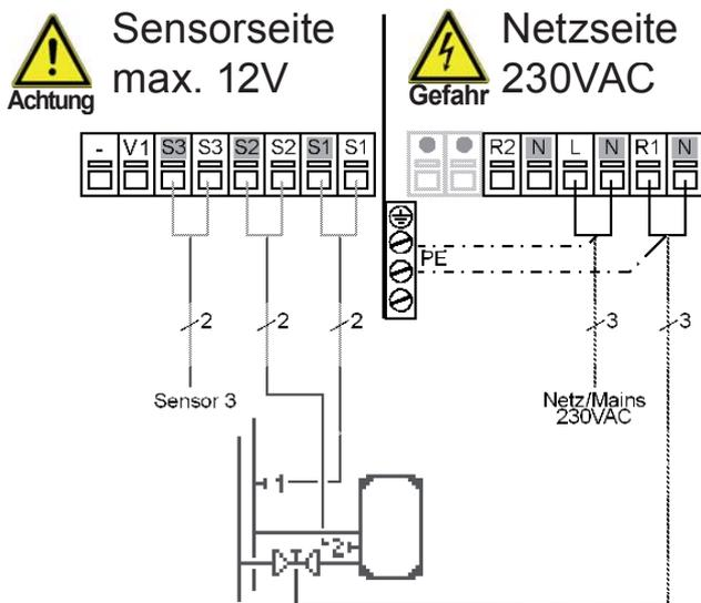
Relais R1 und R2 werden gleichzeitig geschaltet, um z.B. eine Pumpe an R2 anschließen zu können.
