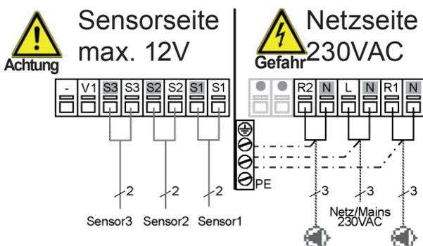
**Kleinspannungen** max. 12VAC/DC Anschluss im linken Klemmraum!
