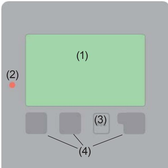
Das Display (1) mit umfangreichem Text- und Grafikmodus ermöglicht Ihnen eine einfache und fast selbsterklärende Bedienung des Reglers.
