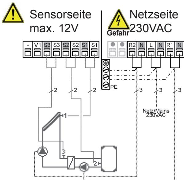
**Kleinspannungen** max. 12VAC/DC Anschluss im linken Klemmraum!
