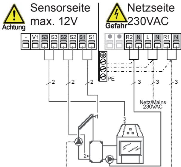
**Kleinspannungen** max. 12VAC/DC Anschluss im linken Klemmraum!
