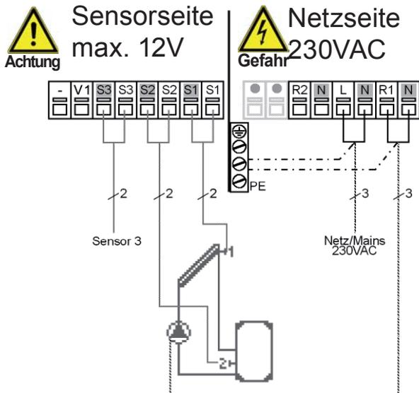
R2 schaltet nur für eingestellte Vorspülzeit mit R1 an, um den Anschluss einer Boosterpumpe zu ermöglichen
