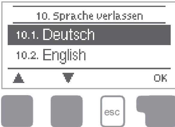
Über das Menü "10. Sprache" kann die Sprache der Menüführung gewählt werden. Bei der ersten Inbetriebnahme erfolgt die Abfrage automatisch.
