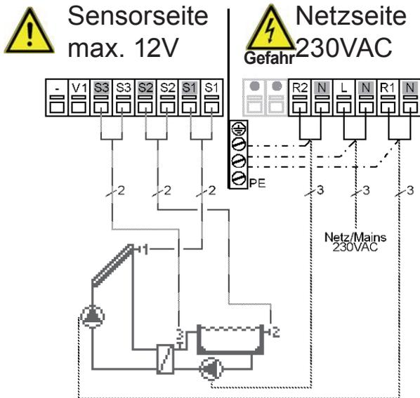
**Kleinspannungen** max. 12VAC/DC Anschluss im linken Klemmraum!
