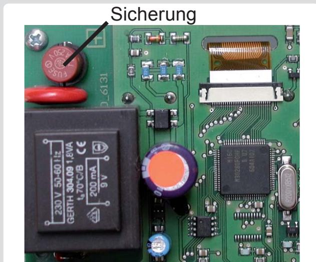
Hat der Regler trotz eingeschalteter Netzspannung keine Funktion und Anzeige mehr, so ist es möglich, dass die interne Gerätesicherung defekt ist. Dann das Gerät wie unter C beschrieben öffnen, alte Sicherung entfernen und überprüfen. Die defekte Sicherung wechseln, externe Fehlerquelle (wie z.B. Pumpe) finden und austauschen.
