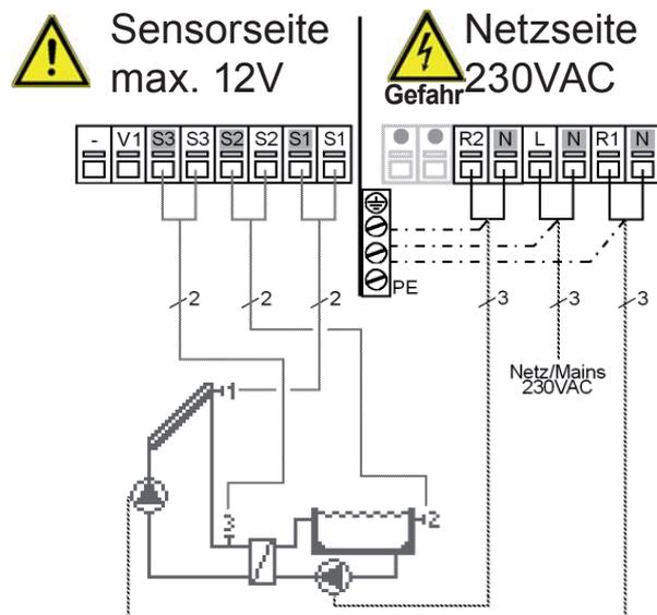
**Kleinspannungen** max. 12VAC/DC Anschluss im linken Klemmraum!
