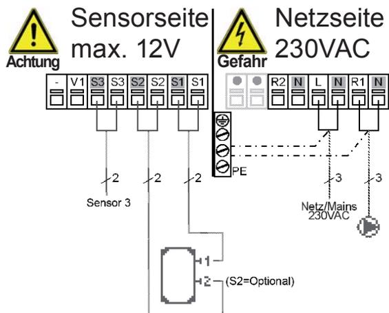
Relais R1 und R2 werden gleichzeitig geschaltet, um z.B. eine Pumpe an R2 anschließen zu können.
