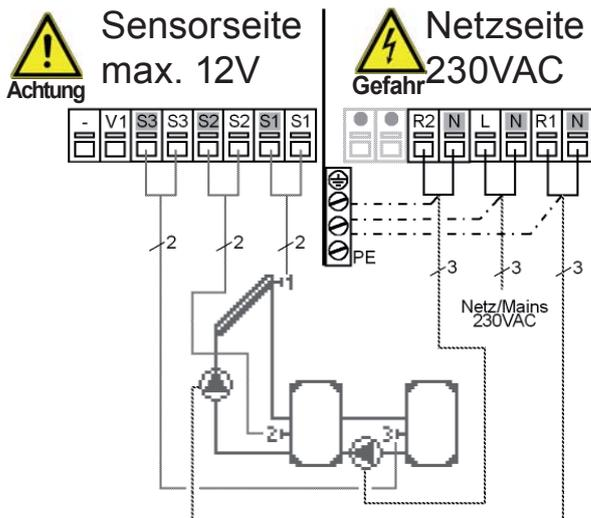
**Kleinspannungen** max. 12VAC/DC Anschluss im linken Klemmraum!
