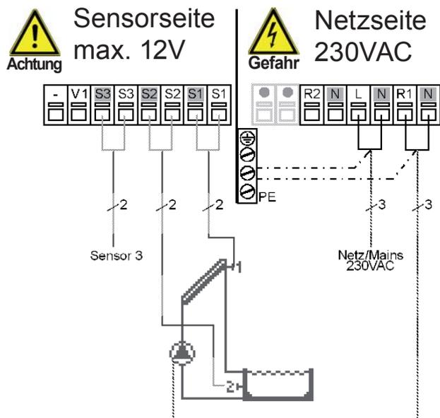
Relais R1 und R2 werden gleichzeitig geschaltet, um z.B. eine Pumpe an R2 anschließen zu können.
