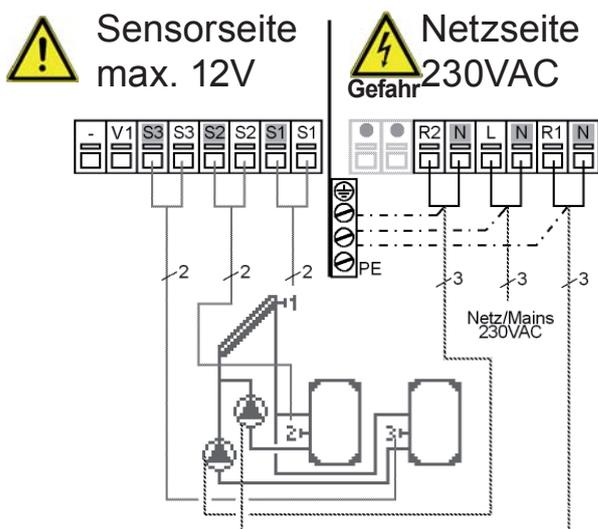
**Kleinspannungen** max. 12VAC/DC Anschluss im linken Klemmraum!
