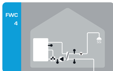
Frischwasserregelung mit Zonenventil
