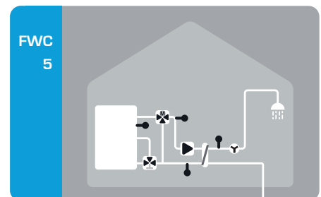
Frischwasserregelung mit primärseitigem Mischventil, Zonenventil
